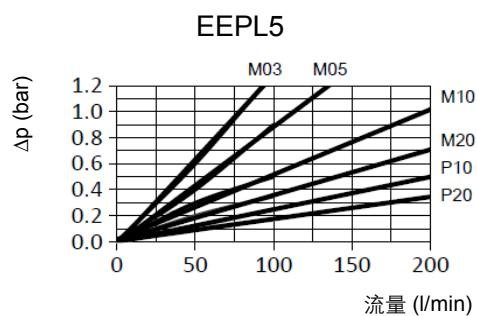
压差流量特性曲线适用于密度为 $0.86 \text{ kg/dm}^3$ 和运动粘度为 $30 \text{ mm}^2/\text{s}$ 的矿物油。
