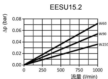
压差流量特性曲线适用于密度为  $0.86 \text{ kg/dm}^3$  和运动粘度为  $30 \text{ mm}^2/\text{s}$  的矿物油。
