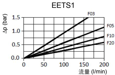
压差流量特性曲线适用于密度为  $0.86 \text{ kg/dm}^3$  和运动粘度为  $30 \text{ mm}^2/\text{s}$  的矿物油。
